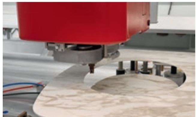
Es posible equipar el plano de trabajo con un máximo de 40 ventosas telescópicas, que pueden variar en dimensiones y forma. Las ventosas telescópicas son gestionadas automáticamente por el software de la máquina y programadas mediante funciones CAM específicas desarrolladas por Intermac.
